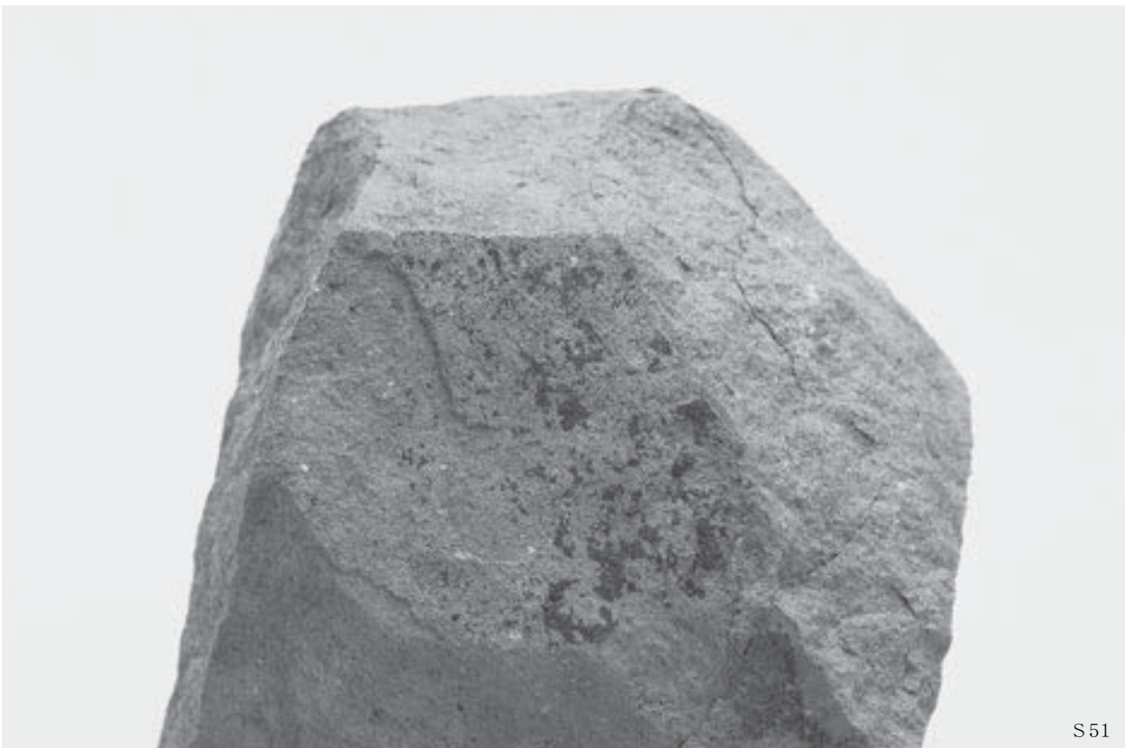
2 鉄床石 S 51 鉄滓附着部拡大
